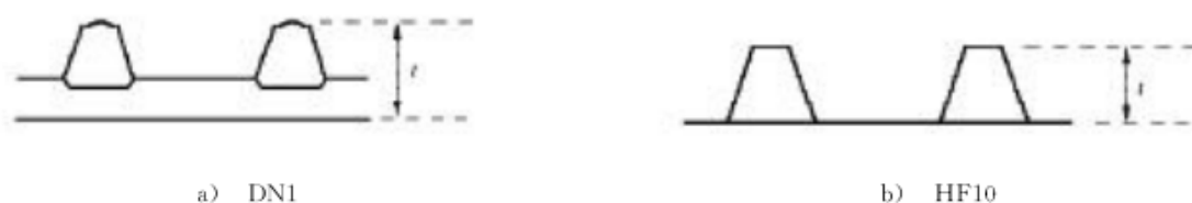
图 3 DN1、HF10 厚度的测量部位
